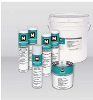
**Пластичные смазки** («консистентные») – смазочные материалы, проявляющие в зависимости от нагрузки свойства жидкости или твердого тела. Пластичные смазки состоят из жидкого масла, загустителя, присадок и наполнителей. Частицы загустителя (дисперсной фазы) образуют структурный каркас, в ячейках которого удерживается масло (дисперсионная среда).
