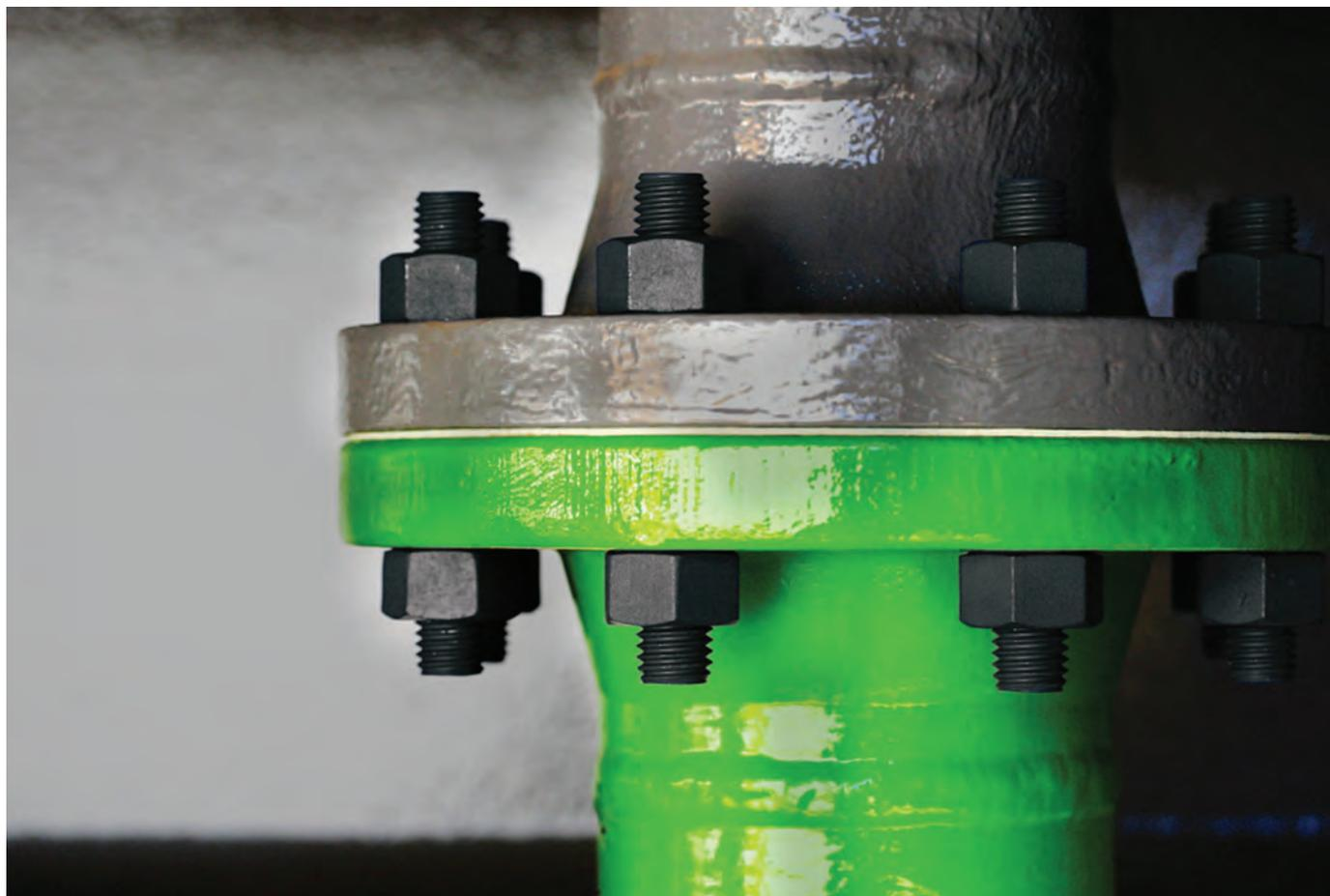
Рисунок 1. На стыках и фланцах трубопроводов силиконовые герметики *Dow Corning* могут помочь предотвратить утечку и подтекания в жару и в холод. Смазочные пасты *Molykote* помогают гарантировать нужный крутящий момент затяжки на резьбовых соединениях.
