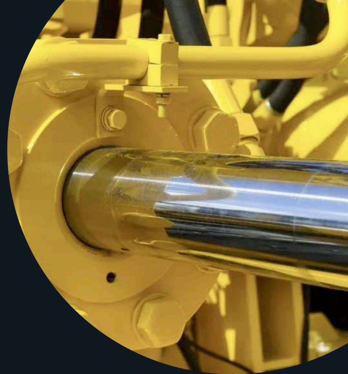
Покрытие, нанесенное на гильзу гидроцилиндра, предотвращает скачкообразное движение, максимально снижает потери на трение и ощутимо увеличивает срок службы оборудования.
