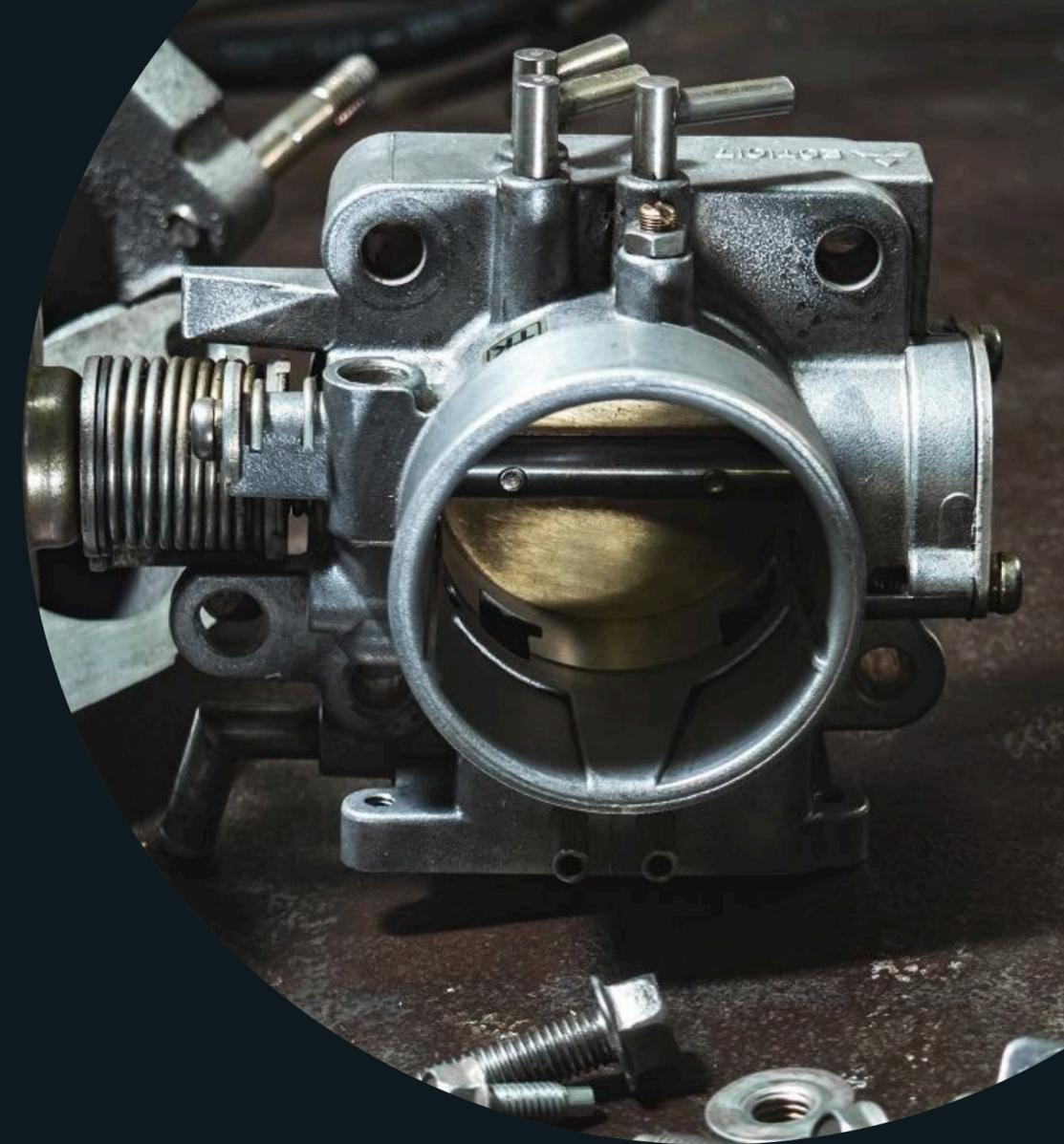
В результате загрязнения и износа дроссельная заслонка перестает обеспечивать герметичность в закрытом положении. При этом нарушается стабильность оборотов холостого хода и ухудшается динамика разгона.
