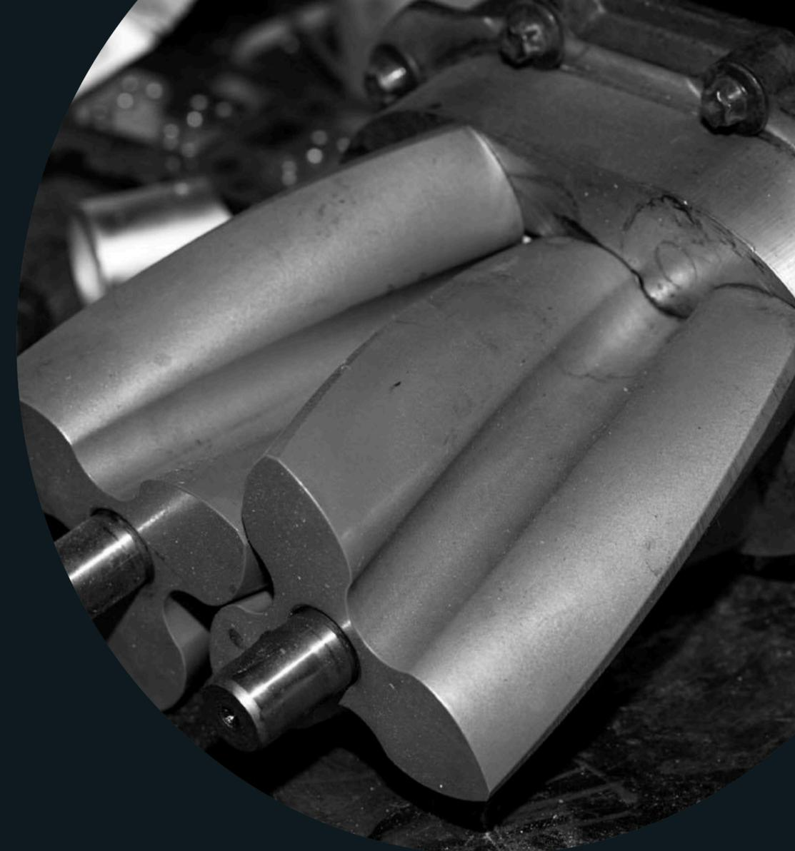
Покрытие MODENGY ДЛѦ ДЕТАЛЕЙ ДВС на роторах выполняет функцию динамического уплотнения, предотвращает схватывание и появление задиров на деталях, снижает уровень шума при работе компрессора.
