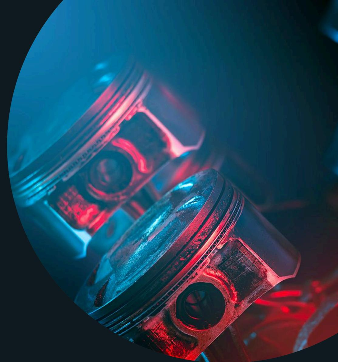
Высокие температуры и повышенное трение приводят к износу юбок поршней. Особенно активно этот процесс идет в период приработки двигателя и в условиях масляного «голодания».
