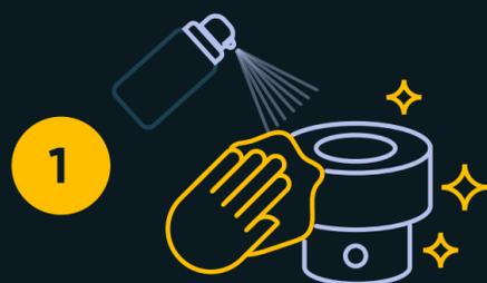
1 Для подготовки и очистки поверхности используйте Специальный очиститель-активатор MODENGY. Только он гарантирует хорошую адгезию
