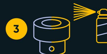
3 Распылите покрытие из баллона на обрабатываемую поверхность с расстояния 20-30 см
