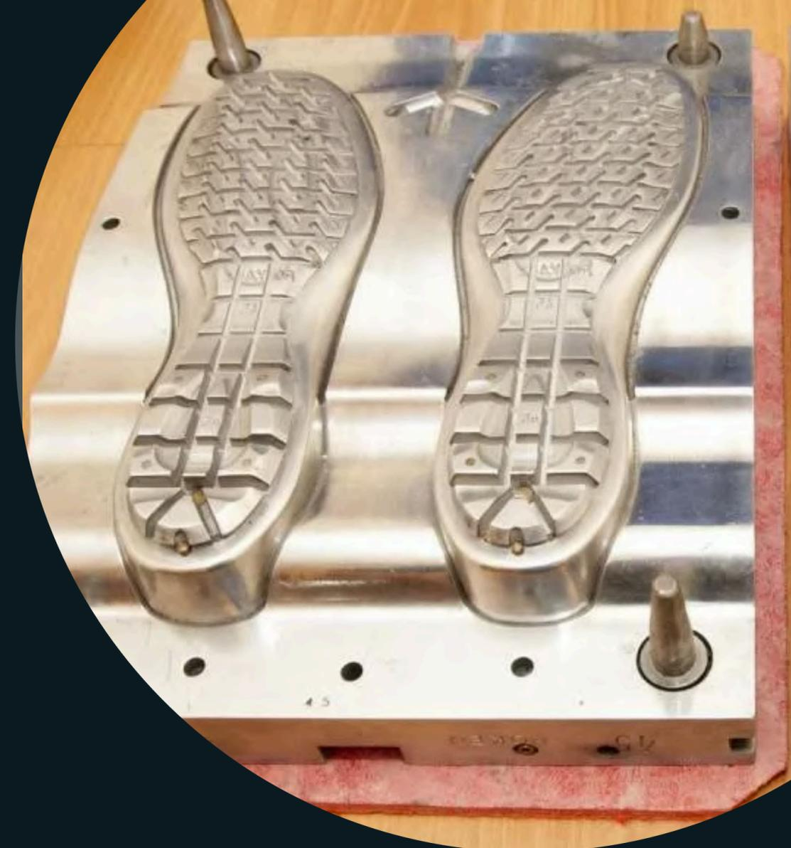
Направляющие скольжения и толкатели пресс-форм работают при значительных нагрузках и высоких температурах. При этом в парах трения металл-металл образуются задиры и схватывания, что негативно влияет на производственный процесс.
