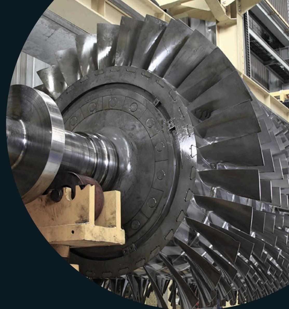
**MODENGY 1001** наносится на хвостовики лопаток турбин и гарантирует легкую сборку и демонтаж при обслуживании и ремонте.
