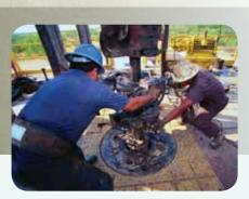
Противозадирная паста Molykote® с твердыми не содержащими металлов смазками снижает истирание резьбы на вращающемся бурильном оборудовании и помогает соблюдать производственный график.
