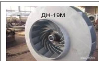
Центробежный или осевой вентилятор, который устанавливают за котлоагрегатом для удаления газообразных продуктов сгорания топлива из котельных агрегатов или промышленных и отопительных печей
