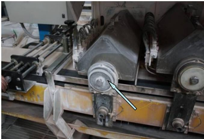
**Условия работы подшипника режущей головки машины резки керамической плитки:**
