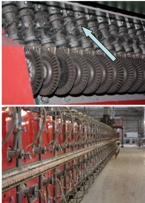
**Привод конвейера печи обжига керамической плитки работает при следующих условиях:**
