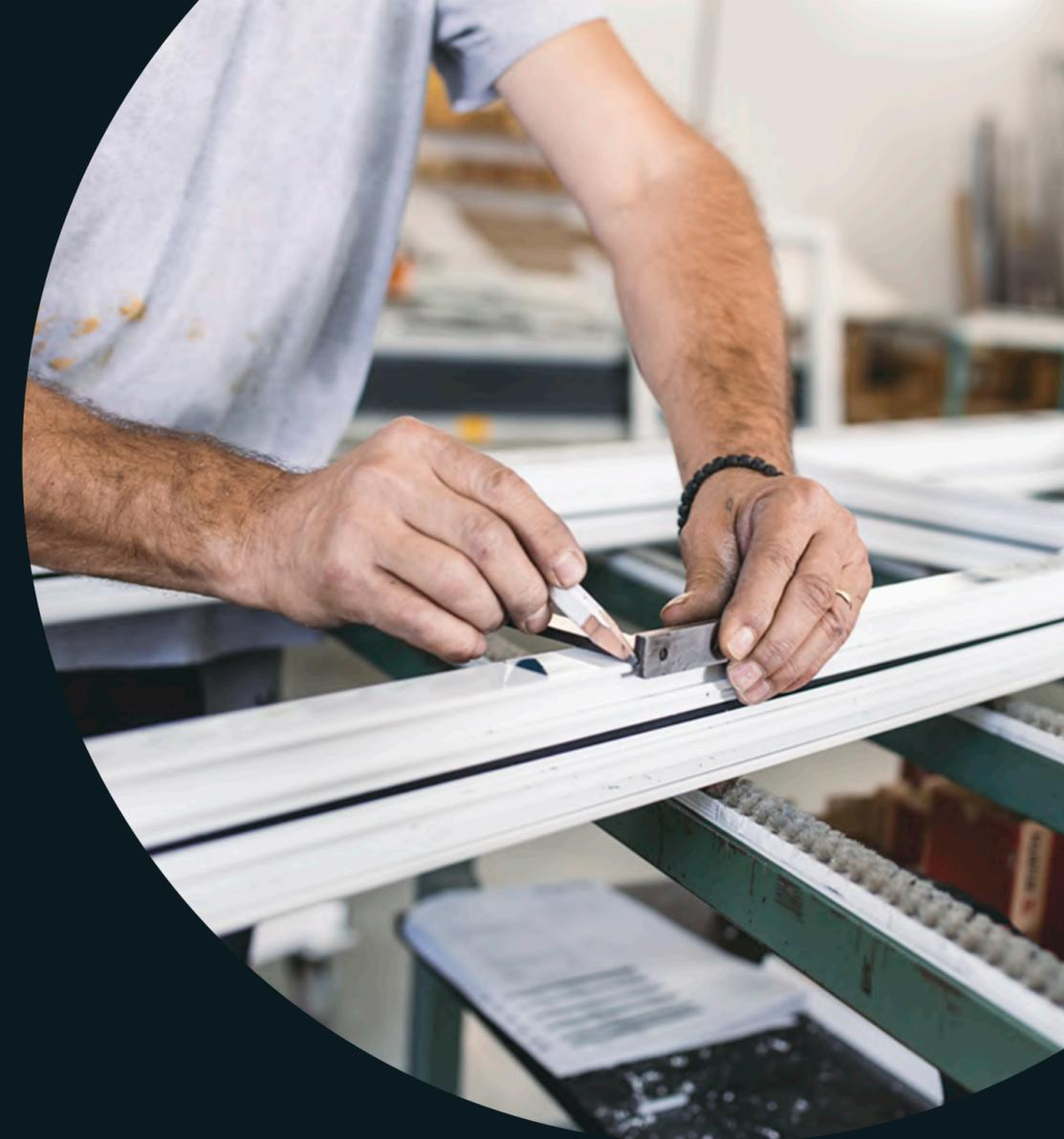
**MODENGY 1007** наносится на ножи гильотин на производствах оконного профиля. Покрытие создает на обрабатываемых поверхностях гладкий антиадгезионный слой, который предотвращает налипание ПВХ.
