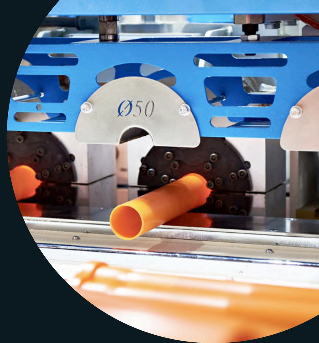
От состояния контактных поверхностей ножевого узла экструдеров зависит качество изготовления полимерных изделий.
