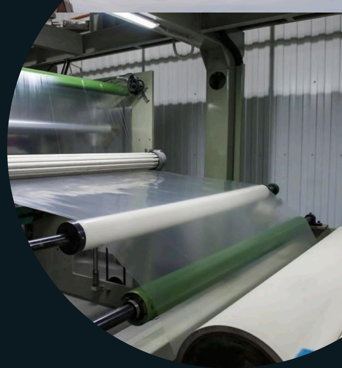
**MODENGY 1006** и **MODENGY 1066** с низким коэффициентом трения и высокой термостойкостью наносят на калибраторы, чтобы предотвратить образование дефектов на полотне полимерной пленки.
